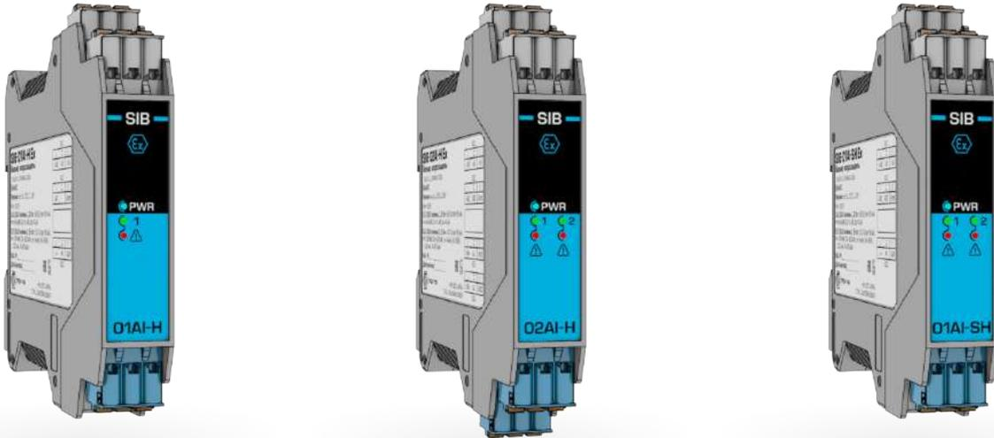
Изолирующий повторитель аналогового сигнала 0(4)...20 мА из взрывоопасной зоны, «прозрачный» для двустороннего обмена по протоколу HART. Может быть использован для питания датчика. Трехсторонняя изоляция вход/выход/питание. Индикация обрыва и короткого замыкания линии связи с датчиком. SIB-01AI-SH обеспечивает дополнительно функцию разветвителя входного сигнала на два выходных.
